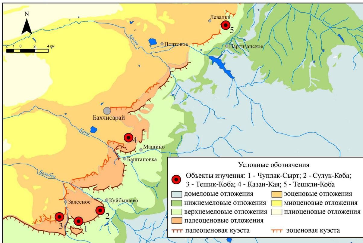
Рис. 1. Геологическое строение юго-западного Предгорья (по [8, 9]) и расположение изученных объектов.
