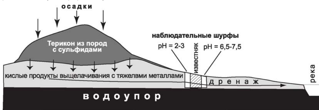
Рис. 5. Заградительный кислотный барьер на пути кислых вод с тяжелыми элементами, образующимися при окислении горных отвалов.
