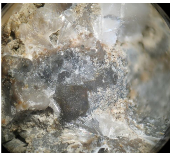
Рис. 2. Звездчатые сростки кристаллов арагонита и прозрачного кальцита призматической формы на галечном материале конгломератов. Увел.8.
