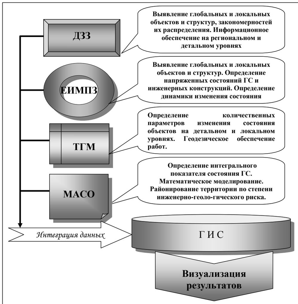
Рис. 4. Технологическая схема комплексного мониторинга ГС.
