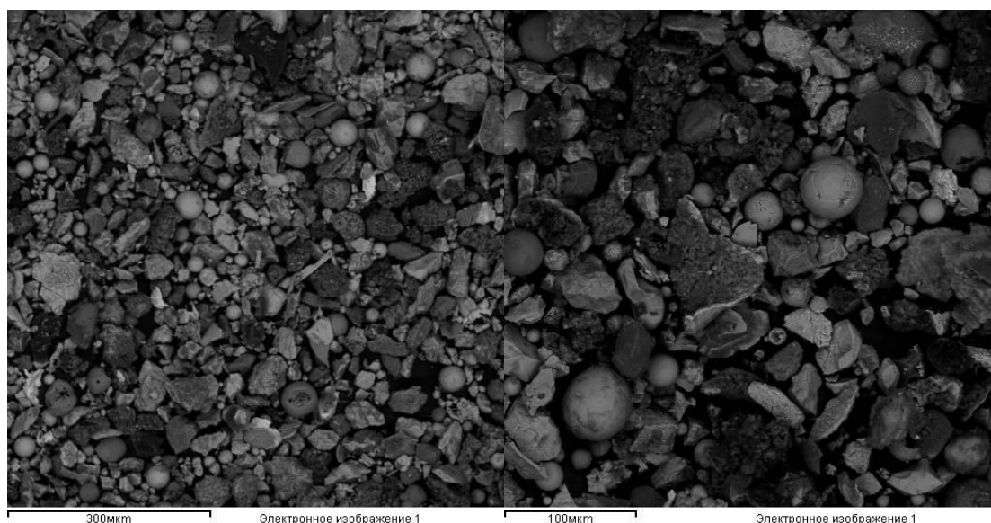
Рис. 1. Электронные изображения образцов атмосферной пыли фракции <0,063 мм
