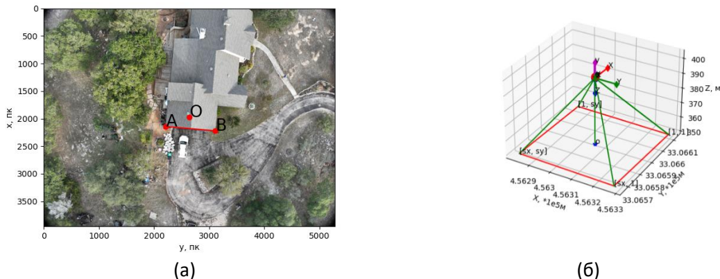
Рис. 10. Изображение и главная точка (а), ракурс съёмки (на примере тестового образца для вида 4)
